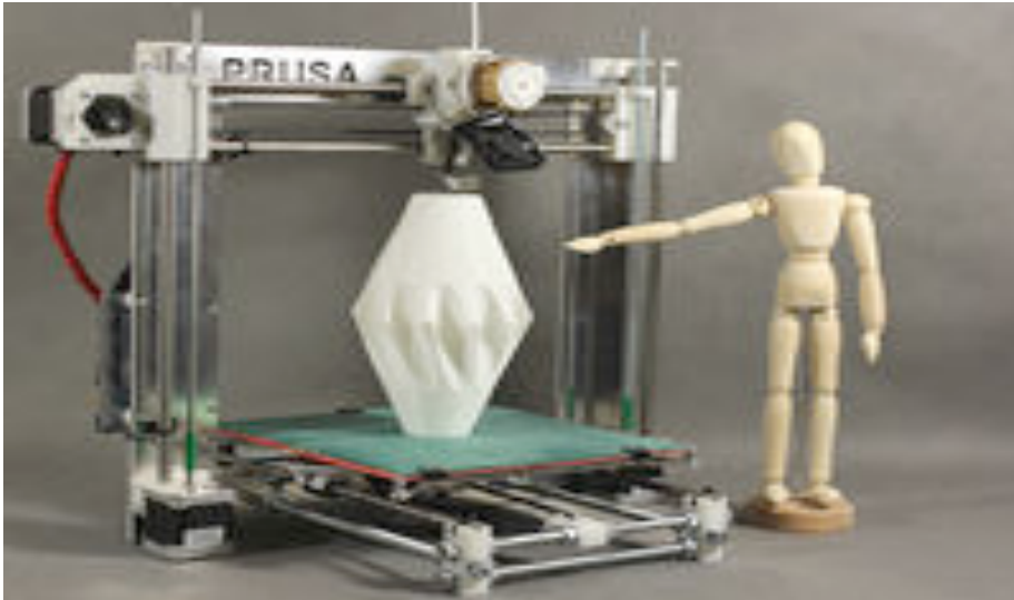
Şekil 2. RepRap Projesi 3 Boyutlu Yazıcılardan Bir Örnek
