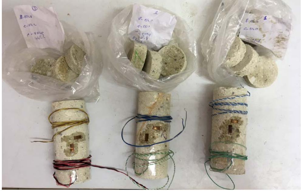
Resim 3.5 Örnekler üzerine strain gauge yerleştirilmesi
