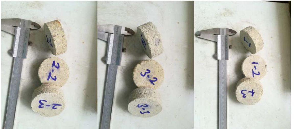
Resim 3.3 Birim hacim ağırlık deneyleri için hazırlanan örnekler
