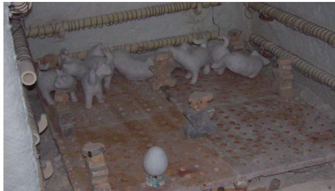
Şekil No 64: Fırına Dizme İşlemi.
