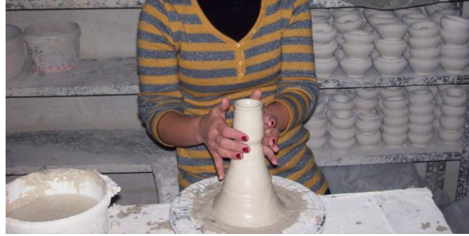
Şekil No 57: Çamura Genel Şeklinin Verilmesi.
