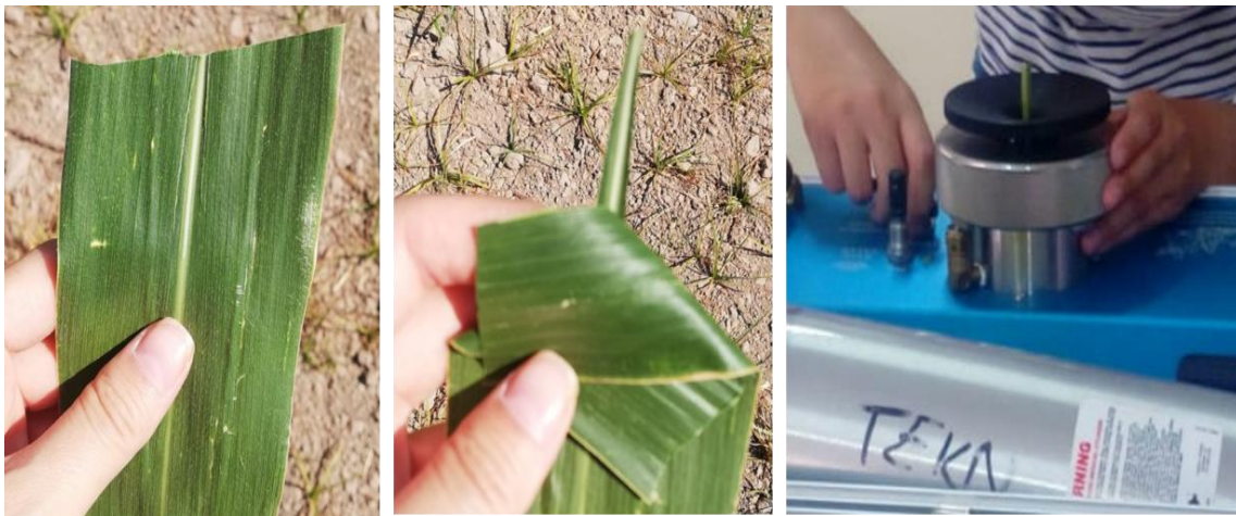
Şekil 1. Yaprak su potansiyeli ölçümleri
