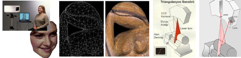
Şekil 6. Lazer Tarama Uygulama Örnekleri ve Şematik Görünümü (Web 25).
