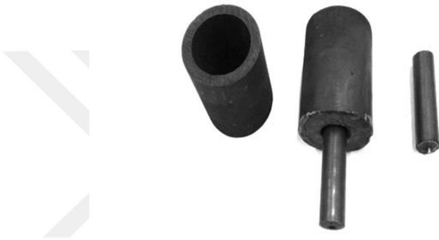
Şekil 3.8 .Grafitten yapılmış Pota, Huni ve Numune Kalıbı [4]
