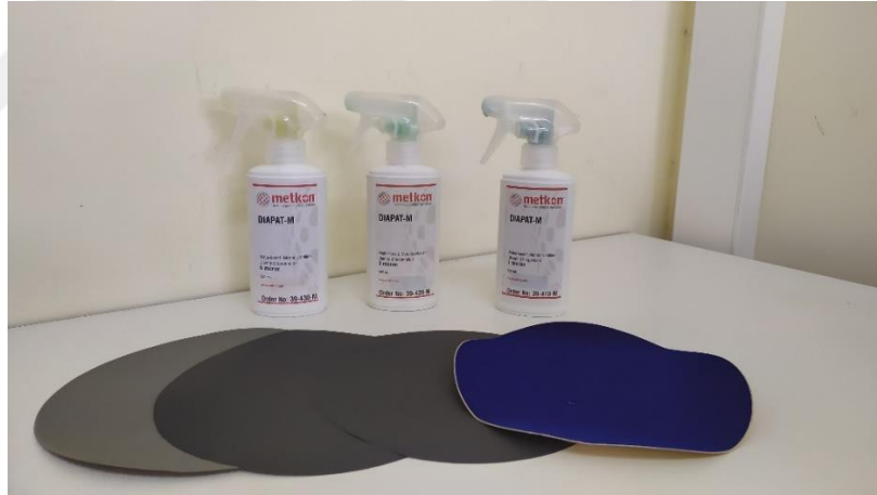
Şekil 3.22. Parlatma işleminde kullanılan zımpara, keçe ve süspansiyonlar
