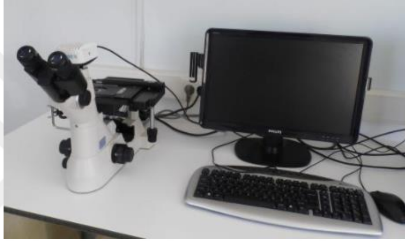
Őekil 3. 18. Optik mikroskop ve CCD kameradan oluřan grnt sistemi
