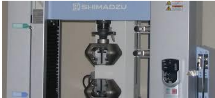
Şekil 3.24. Çekme-basma test cihazı [58]
