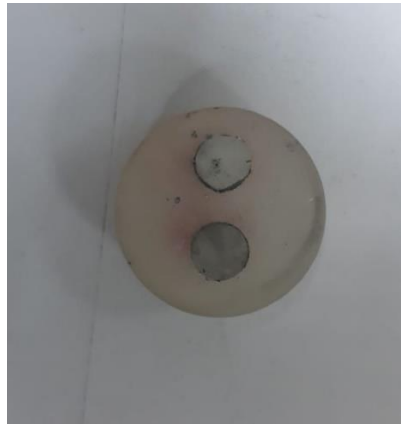
Şekil 3.20. Epoksi-resin ile kalıplanmış numunelerin resmi
