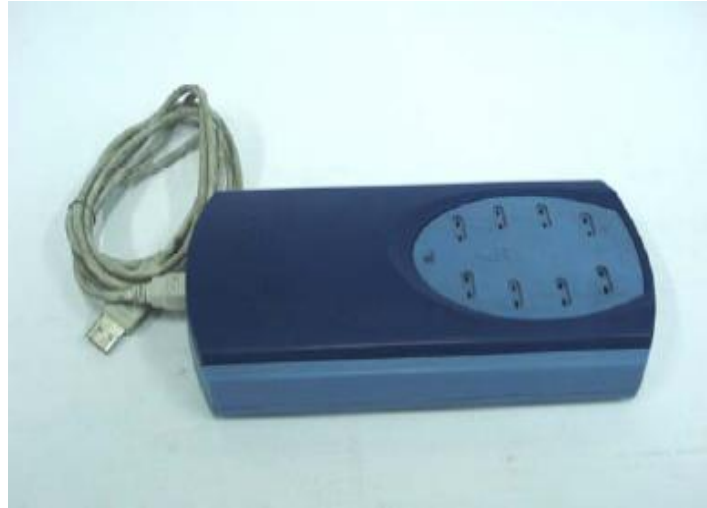
Şekil 3.15. Sıcaklık deđişimlerinin kaydedilmesinde kullanılan sıcaklık kaydedicisi [57]
