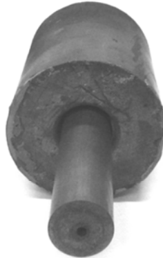
Şekil 3.11. Numune dökümünde kullanılan huni.
